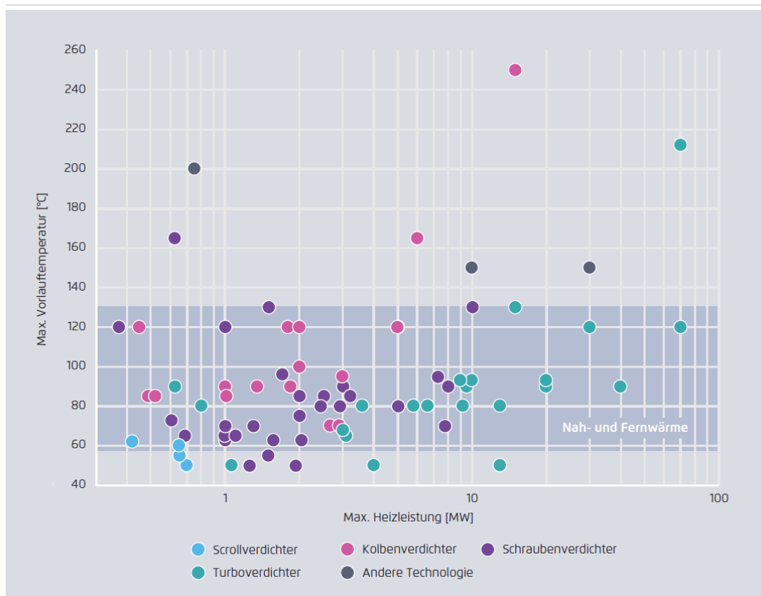
Obrázek 26. Výkonové řady dle typu kompresoru a výstupní teploty (zdroj Fraunhofer IEG)
